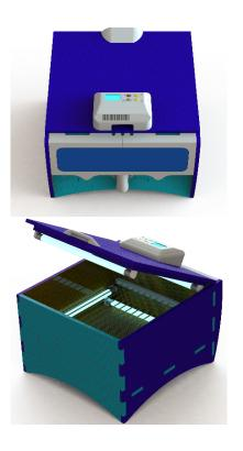
El segundo dispositivo, fue diseñado para desinfección unidades de transporte público (figura 4). Este sistema consta de una barra de lámparas UVC recubiertas con TiO<sub>2</sub>, inclinadas sobre un soporte, que se encuentra integrado a una estructura móvil, permitiendo realizar el proceso de desinfección. El dispositivo realiza el recorrido por los pasillos de manera semiautomática, mientras las luces van irradiando y realizando la desinfección.
